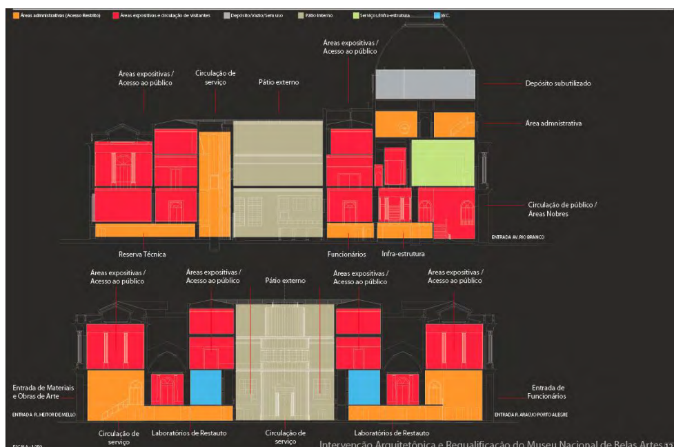
Figura 132 - MNBA: Cortes esquemáticos: usos e organização espacial.
