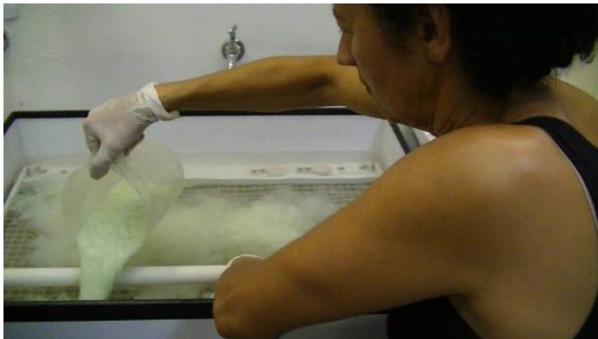
Figura 138 . Inserção de polpa batida e água Fonte: A autora. Foto de 10 de outubro de 2016.
