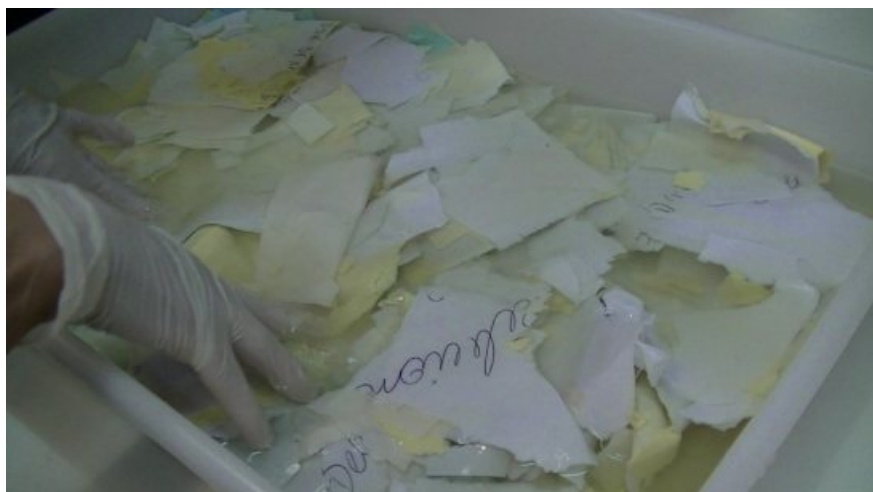
Figura 133 . Papel em água deionizada para remoção de encolagem e impurezas Fonte A autora. Foto de 05 de outubro de 2016.
