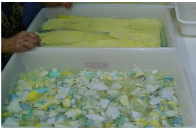
Figura 134 . Papel em solução alcalina Fonte: A autora. Foto de 05 de outubro de 2016.
