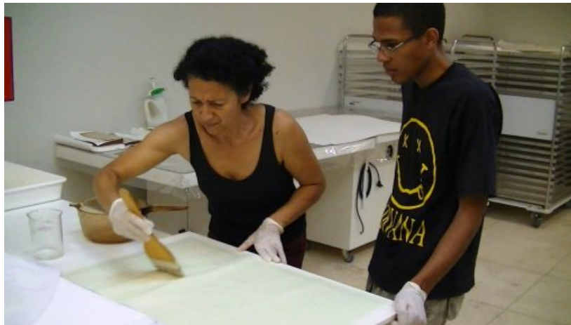
Figura 141 . Encolagem após folha pronta e ainda úmida Fonte: A autora. Foto de 10 de outubro de 2016.
