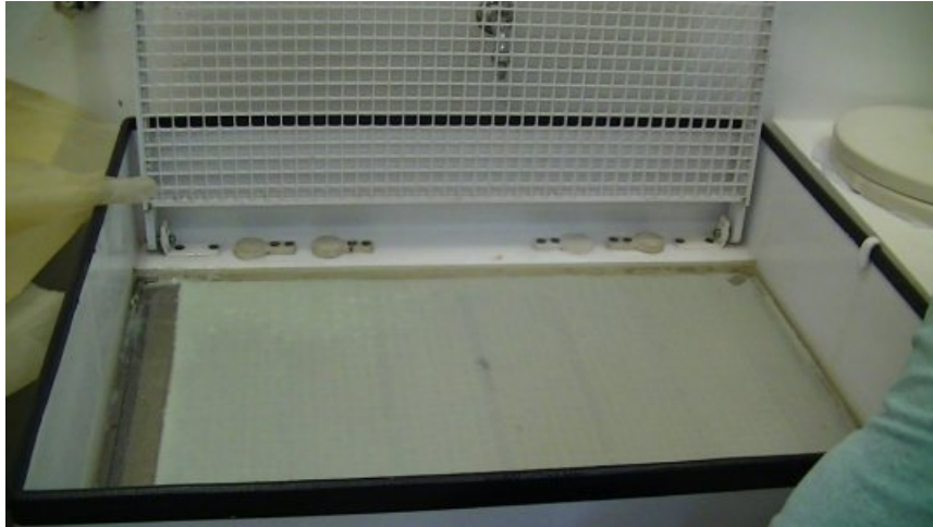
Figura 137 . Colocação de tela de nylon na MOP Fonte: A autora. Foto de 10 de outubro de 2016.
